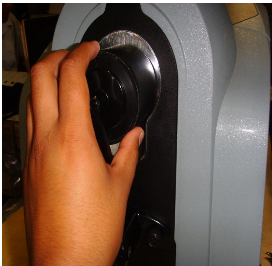
Figura 13 Colocación de estándar de calibración
