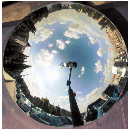
Figura 2.5. Imagen omnidireccional obtenida con un espejo hiperbólico y una cámara de perspectiva convencional. Observe el predominio típico del cielo en la imagen [33].
