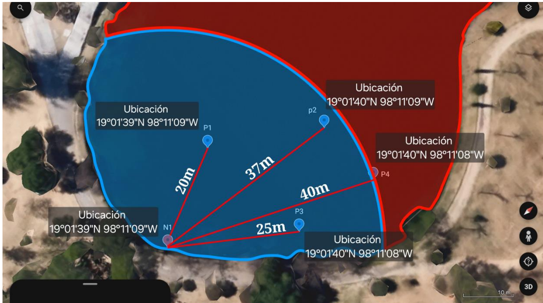
Fig. 4. 10 Zona de cobertura de la WSN y posicionamiento del nodo móvil, correspondiente entorno de medición 2 determinado con la antena incorporada de la tarjeta de desarrollo del nodo fijo y la antena externa incorporada al nodo móvil.
