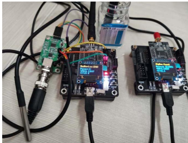
Fig. 1. 2 Red de sensores para el monitoreo de la calidad del agua desarrollada en [15].
