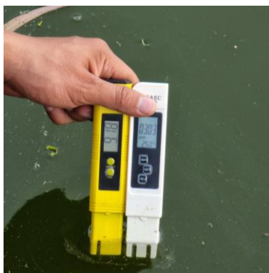
Fig. 4. 9 Instrumentos especializados para medir pH, TDS, y temperatura.
