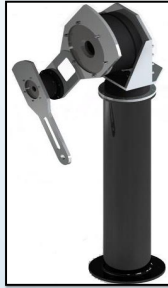
Figura 1. Robot ROTRADI a emplearse para la implementación del controlador de ganancias variables en un brazo robótico.
