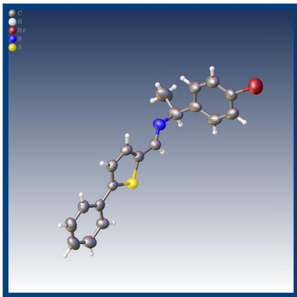
Figura 19: Estructura de rayos X de la ( S )-(+)-[1-(4-bromofenil)-N-(5-feniltiofen-2-metilideno)] etilamina.
