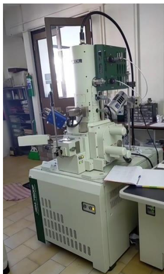
Figura 2.2.6. Detector dispersivo de Rayos-X acoplado a un microscopio electrónico de barrido.
