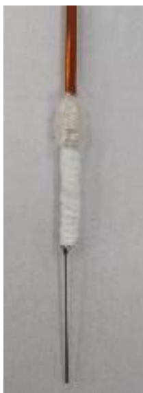
Figura 2.3.1. Colector de corriente de grafito (electrodo) recién preparado impregnado con el material compuesto.
