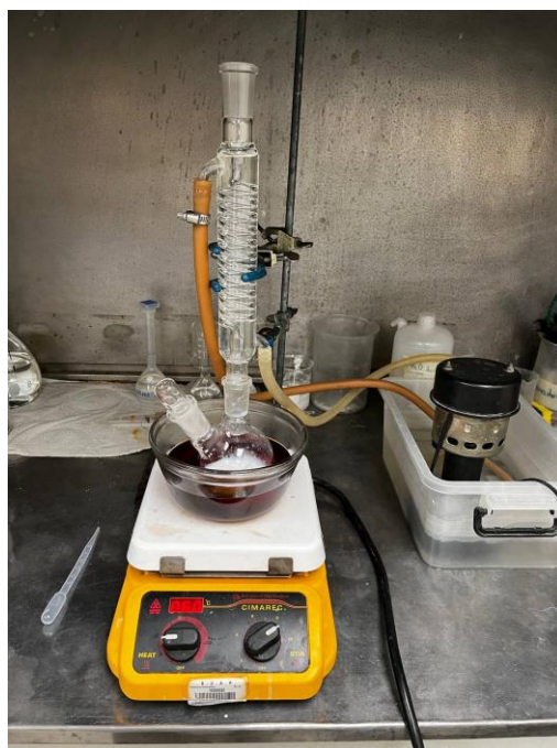
Figura 11. Ensamble del sistema de síntesis.
