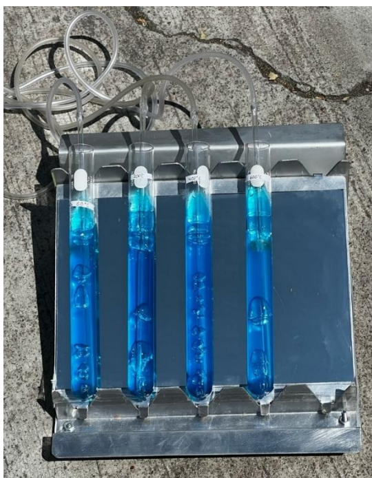
Figura 16. Colector solar con los reactores colocados en orientación norte sur.
