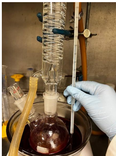
Figura 12. Sistema de síntesis estabilizado a 60 °C.
