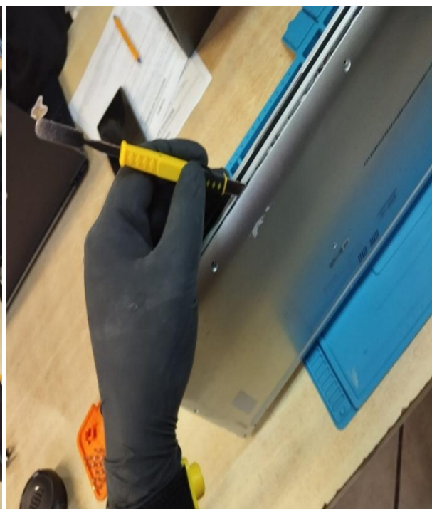
Imagen 114d. Aflojamos las pestañas de la tapa
