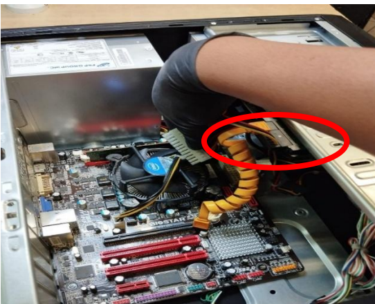
Imagen 49a. extracción de cables del HDD
