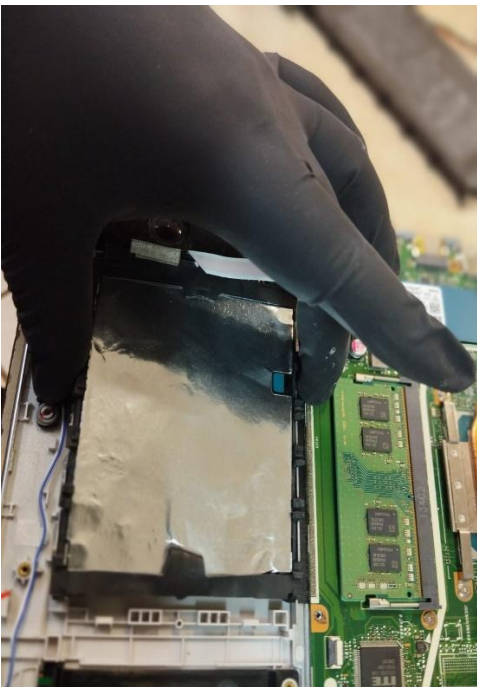
Imagen 151a. Instalación HDD
