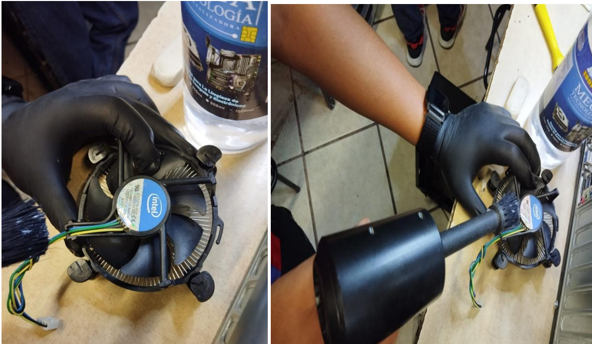
Imagen 66a. Limpieza con pistola de aire. Imagen 66b. Evitamos que el ventilador gire.
