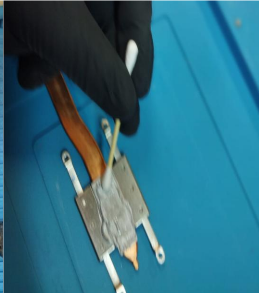
Imagen 124b. Limpieza de disipador
