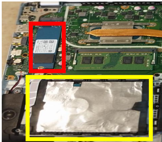
Imagen 119. Cuadro rojo: DISCO SSD NVME Cuadro amarillo: DISCO HDD
