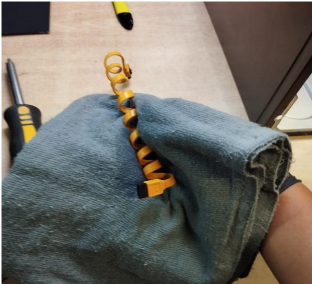
Imagen 54a. limpieza cable SATA
