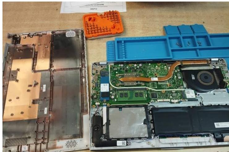
Imagen 114f. Acceso al Hardware de la laptop
