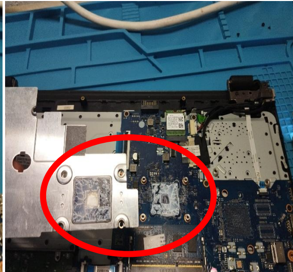
Imagen 127b. Limpieza de pasta térmica
