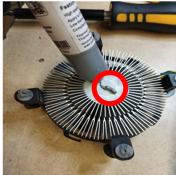
Imagen 92b. Pasta térmica en el disipador
