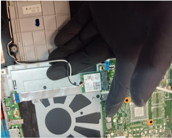
Imagen 129c. Retiramos sus cables
