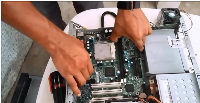
Imagen 177. valoración de Tarjeta madre defectuosa
