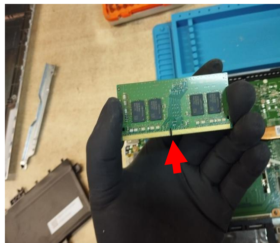
Imagen 117d. Pin bloqueado de RAM
