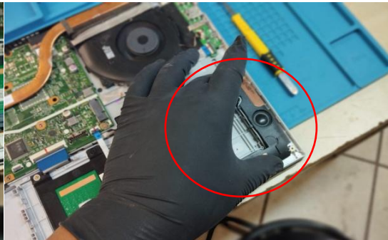
Imagen 153b. Instalación bocina der.
