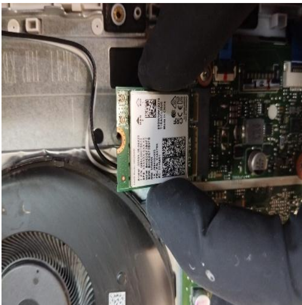
Imagen 143a. Instalación de tarjeta de red
