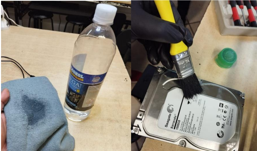
Imagen 57a. Material de limpieza Imagen 57b. limpieza carcasa del HDD
