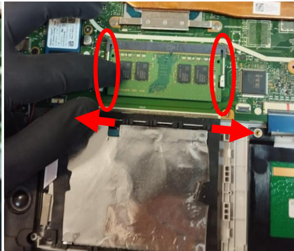
Imagen 117b. Pestañas para retirar RAM
