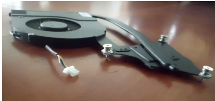
Imagen 33. Sistema de enfriamiento
