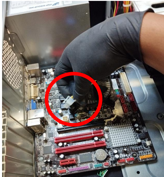
Imagen 49c. Extracción cables de la fuente
