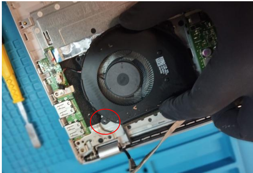
Imagen 144. Fijamos ventilador y tornillos
