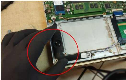
Imagen 153a. Instalación bocina izq.
