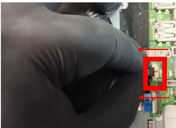
Imagen 123a. Desconectamos ventilador
