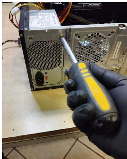
Imagen 50. Tornillos de la fuente
