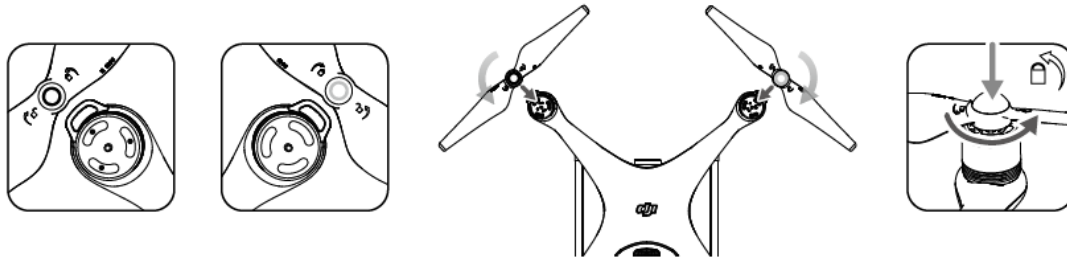
Figura 3.14. Colocación de hélices. Fuente. (DJI, 2015).
