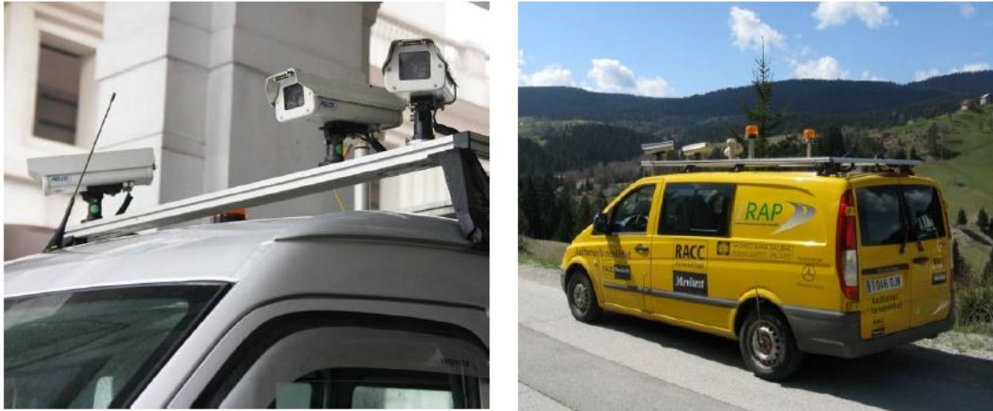
Figura 4.3. Equipo para calificar los elementos de la infraestructura vial. Vehículos especialmente equipados toman imágenes por video de la red vial (izquierda en Vietnam y derecha en Serbia)
