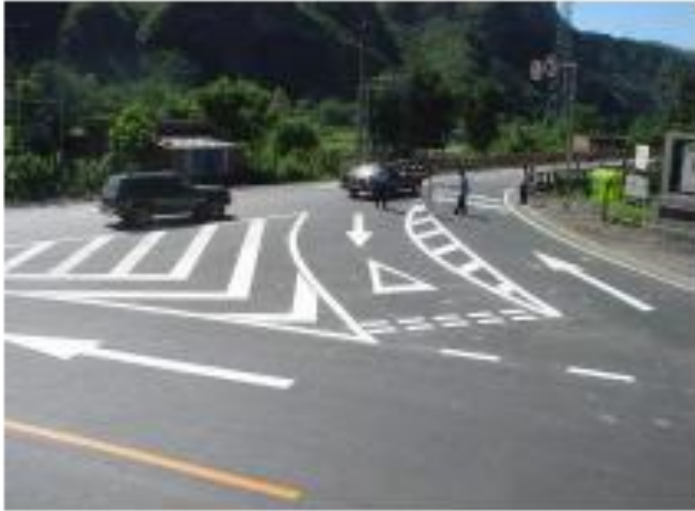
Figura 4.6. Riesgo muy bajo de los ocupantes del vehículo y de los peatones si la delineación y el señalamiento es la adecuada. Factor de Riesgo= 1.00
