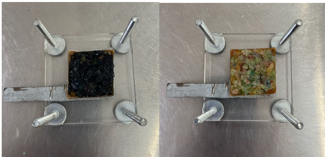
Fig. 34. Pruebas alternativas de electrocatalizador a) hidrogel y carbón lignítico b) hidrogel y Zeolita Clinoptilolita. Fuente: Elaboración propia.
