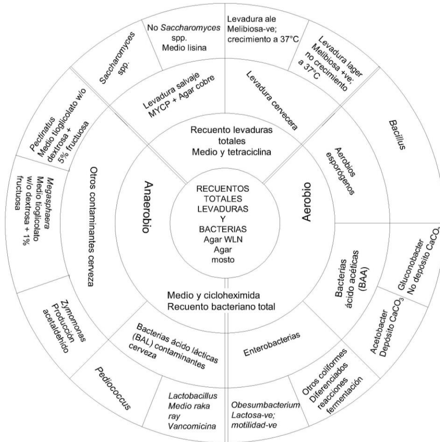
Figura 3. Esquema para la detección y enumeración de microorganismos importantes en cervecería. Fuente: (Cortesía del instituto of Brewing), (Hornsey y Barrado, 2002).
