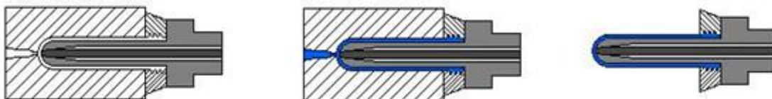
Figura 1.10 Vista lateral del proceso de inyección en una cavidad.
