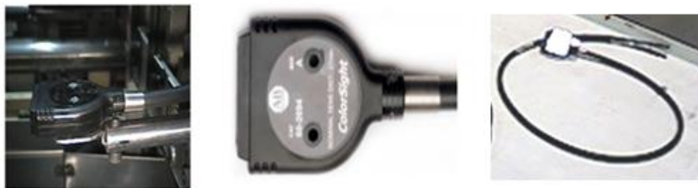
Figura 4.6 Sensor de color con fibra óptica.
