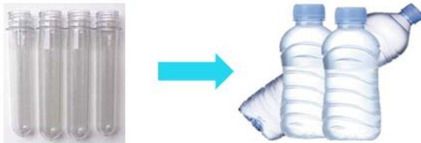
Figura 1.12 Transformación de preforma de PET en botella
