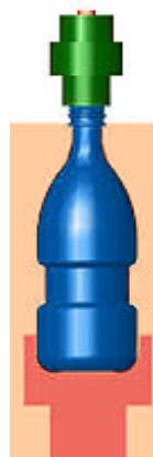
Figura 1.16 Etapa de soplado, botella completamente formada.
