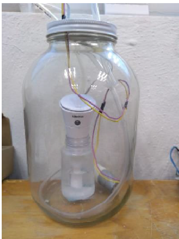
Figura 3.2. Cámara generación vapor de agua (4 L).
