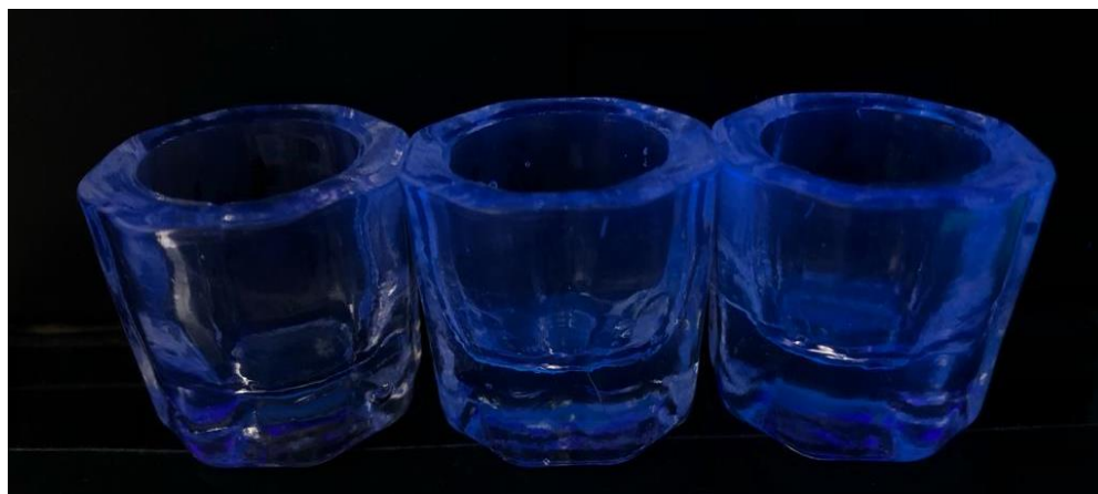
Figura 2. Incorporación de 5,7-dimetoxi-4-fenil-quinolina fluorescente y la resina ortodóncica Ppure-on-touchL® a diferentes concentraciones con la técnica 1 de amasado; de izquierda a derecha, 0.46%, 1.4% y 2.3%.
