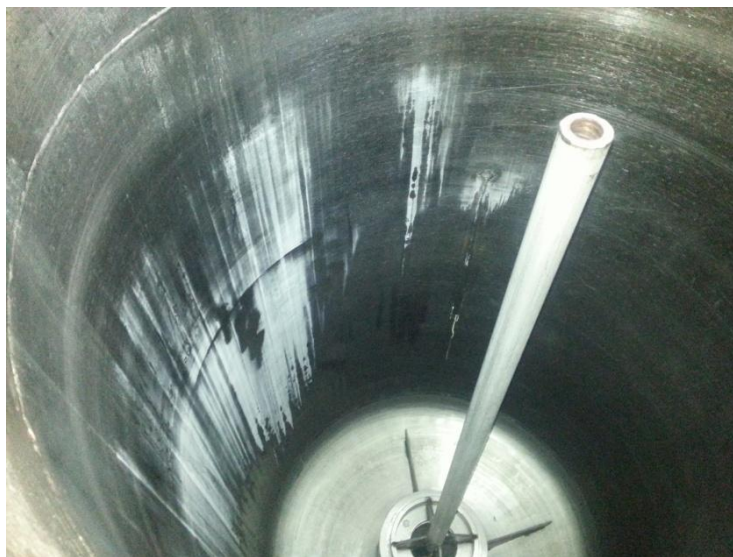
Fig. 2.5 Polvo grisáceo formado por la acumulación de oligómeros en la olla de teñido.
