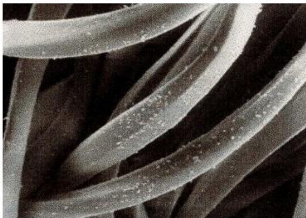
Figura 4.1 Vista microscópica de la tintura convencional hilo 100% poliéster. (Anon., 2014)
