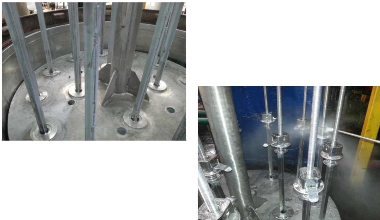
Figura 4.3 Espadas de la olla de tintura sin el uso del dispersante y con el uso del dispersante.
