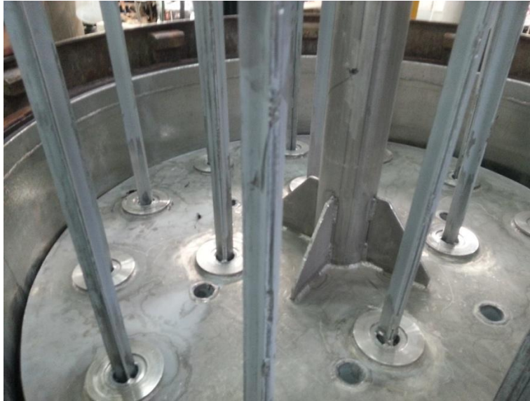
Figura 2.2 Espadas en la olla de tintura con polvo grisáceo (oligómeros)
