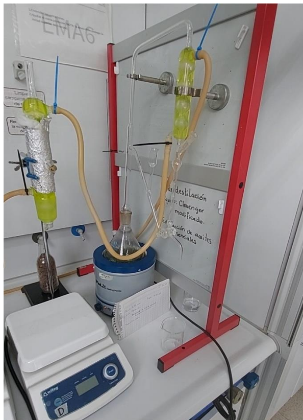
Figura 8. Ebullición del material vegetal en el sistema Clevenger modificado por Oviedo y Orochena (2011), en el que los metabolitos secundarios son extraídos por arrastre de vapor.
