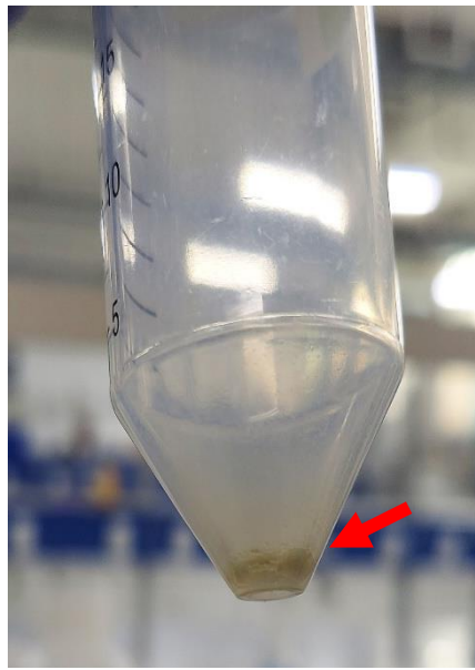
Figura 11. Precipitado de extracto COV en el fondo del tubo “Falcon” (flecha roja) luego de la evaporación del diclorometano, necesario para su refrigeración y preparación en los viales para el análisis por CG-EM.
