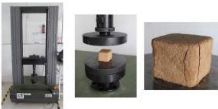
Figura 65. Experimento de resistencia a la compresión mecánica. A la izquierda: Máquina universal CMS UTM-100. En medio: colocación de la muestra en la superficie de prueba. Derecha: fractura en la probeta cúbica de adobe.
