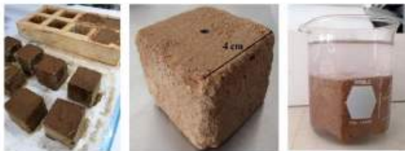
Figura 61. La mezcla de arena, limos, arcillas y agua se vierte en el molde para formar los bloques de 4 X 4 X 4 cm, y una vez secos se someten al tratamiento por inmersión en solución alcalina.
