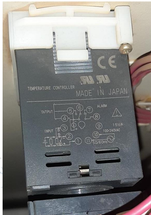
Figura 36.-Diagrama de conexiones de control de temperatura, [1].
