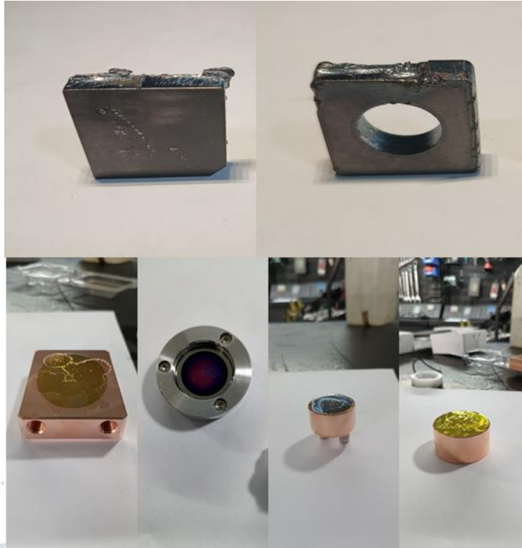
Figura 11.- Piezas con mala calidad de corte y Espejos con condensación.
