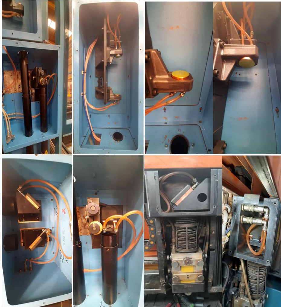
Figura 31.-Sistema de enfriamiento de los espejos de la cadena óptica.
