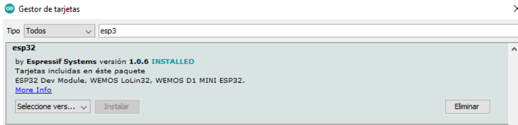
Figura 29. Gestor de librerías de Arduino con el paquete de ESP32 instalado
