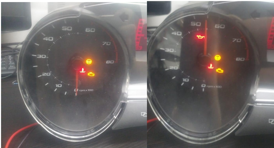
Figura 84. Cuadro de instrumentos, a la izquierda sin recibir mensa y a la derecha recibiendo el valor de las revoluciones en la trama CAN
