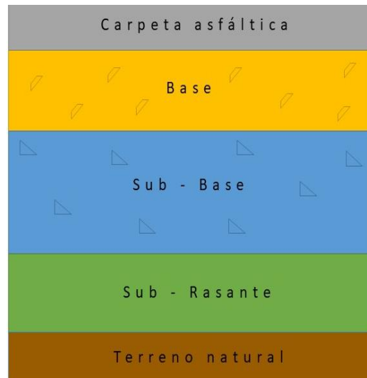
Ilustración 2. Estructura general de un pavimento.
