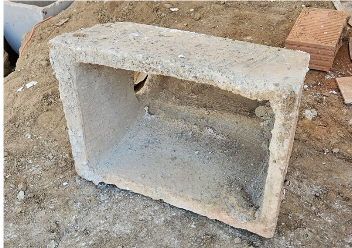
Imagen 56 Registro sanitario prefabricado, Empresa 1. Fuente: Propia
