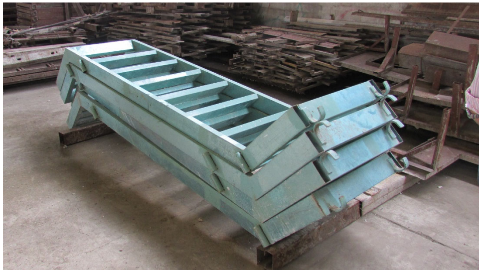
Imagen 65 Escaleras para andamios, Empresa 5. Fuente Propia
