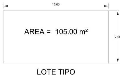
Figura 4.2. Croquis de lote tipo según Artículo 27 del Reglamento para la fusión, subdivisión, retotificación y fraccionamiento de terrenos para el Estado de Veracruz – Llave.
