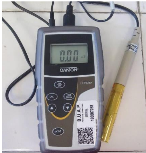
Figura 8. Conductronic modelo OAKTON COND 6+
