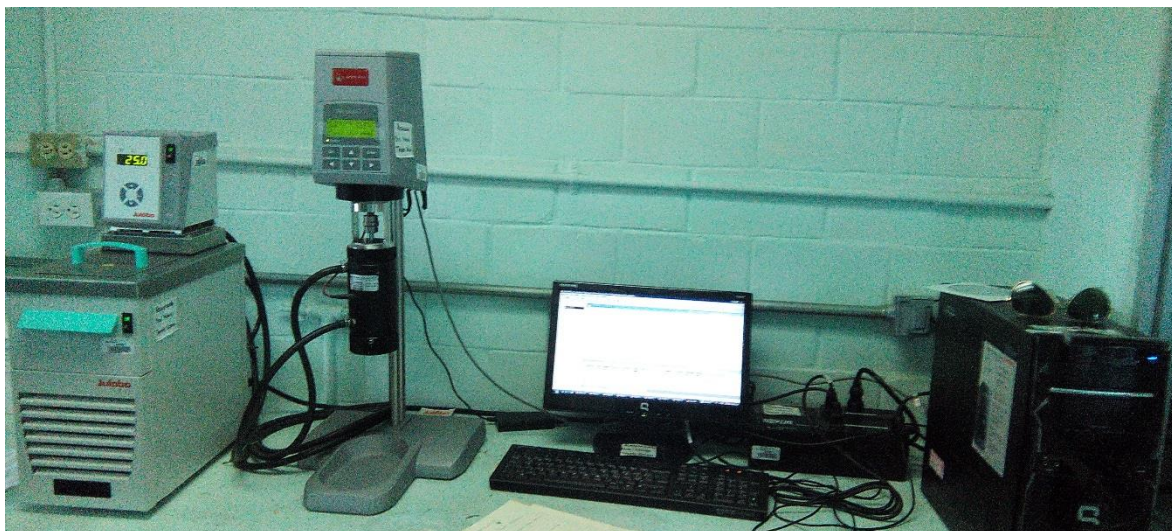
Figura 9. Reómetro de AntonPaar modelo RheolabQC.
