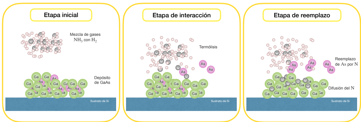
Figura. 2.4: Esquema del proceso de Nitruración
