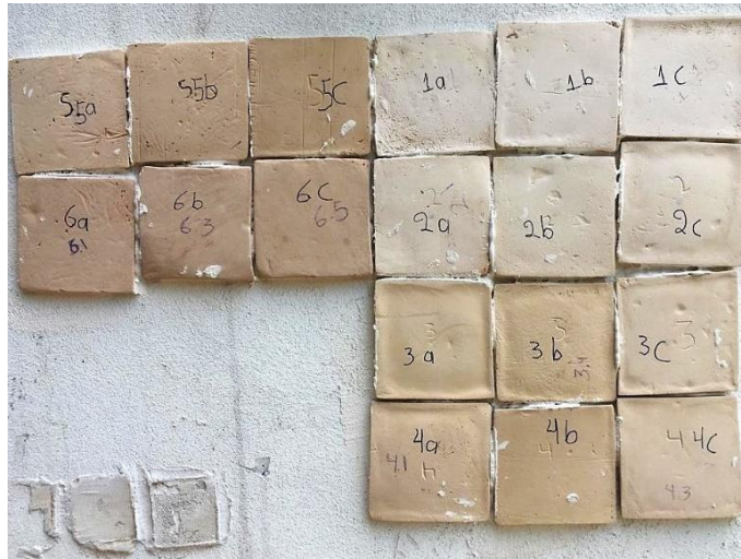
Figura 3.3 Muestras de losetas utilizadas con diferentes concentraciones (1) 100% barbotina contaminada, (2) 80% barbotina y 20 % piezas defectuosas, (3) 60% barbotina contaminada y 40% piezas defectuosas, (4) 40% barbotina contaminada y 60% piezas defectuosas, (5) 20% barbotina contaminada y 80% piezas defectuosas, (6) 100% piezas defectuosas
