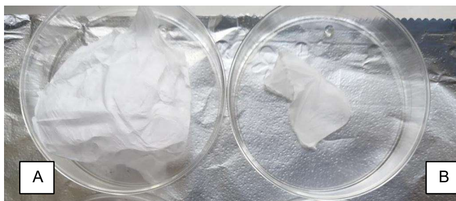
Figura 3.2. A) Fibra obtenida sin proceso de reticulación. B) Fibra obtenida con proceso de reticulación. Extraído de: Cámara digital.
