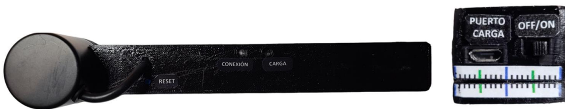
Figura 59. Vista de los controles, indicadores y puerto en el goniómetro digital.
