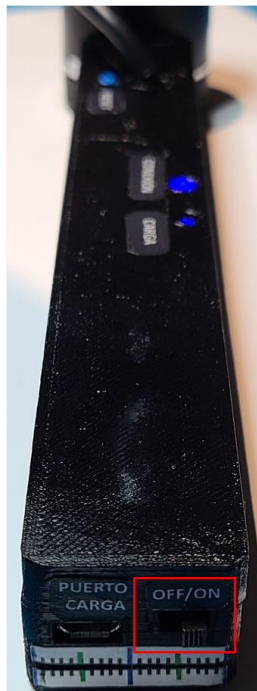
Figura 66. Ubicación del switch de encendido y apagado.
