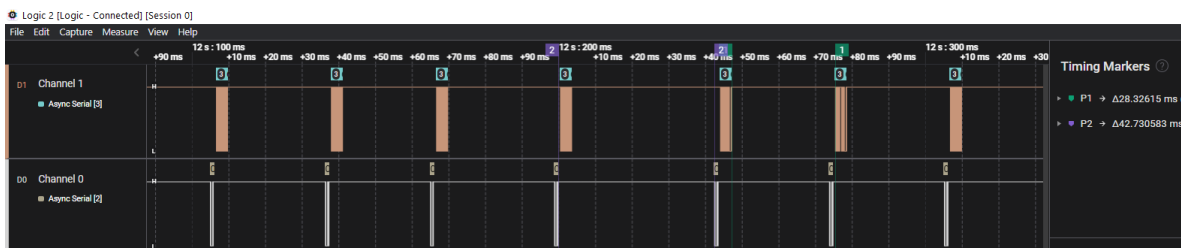
Figura 60. Medición de tiempo entre envío de datos.
