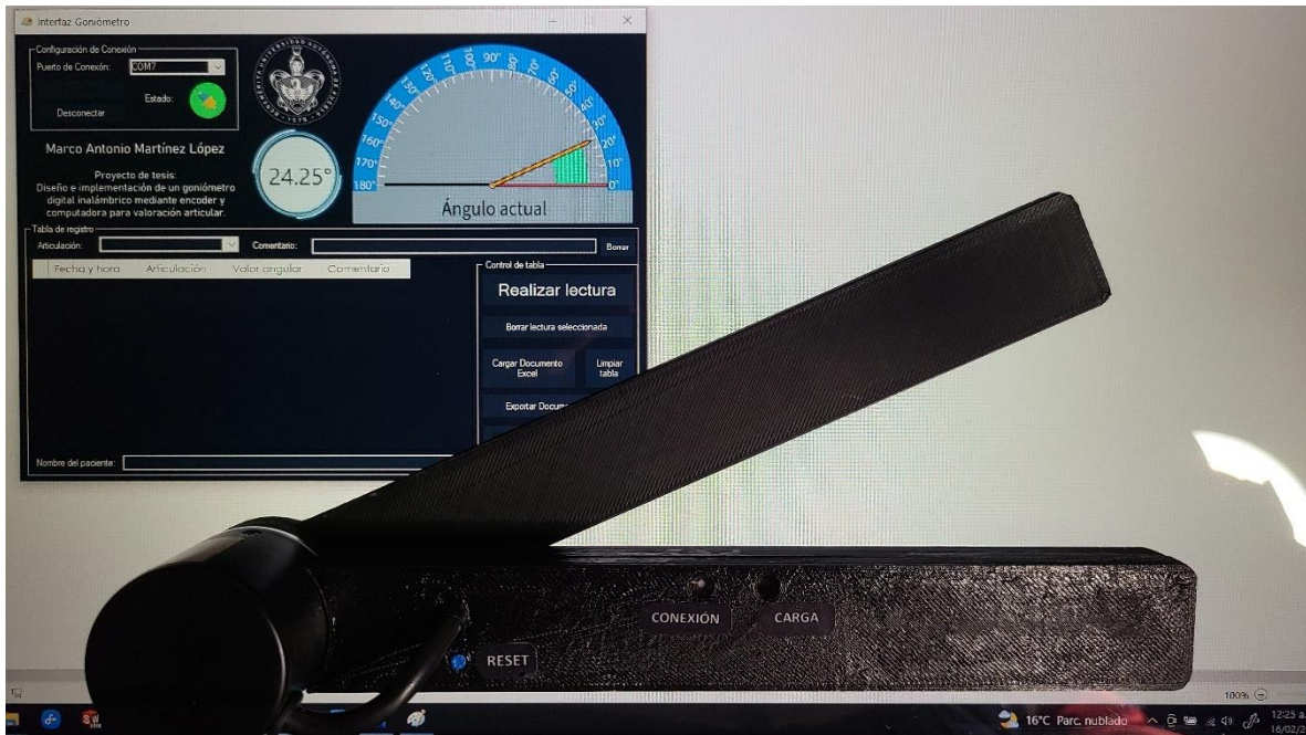
Figura 83. Vista de la interfaz en conjunto con el goniómetro digital.
