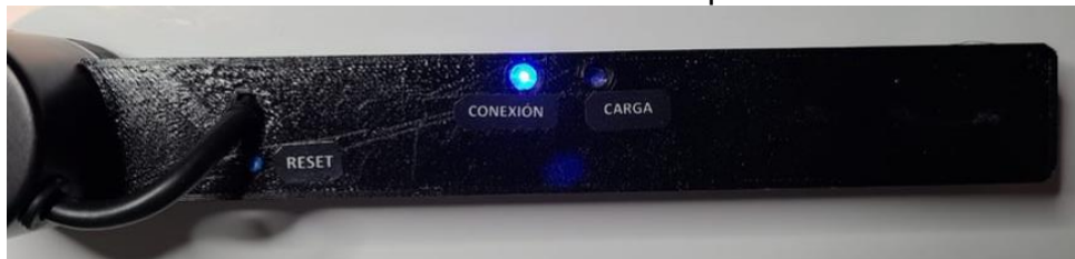
Figura 82. Indicador LED del estado de conexión.
