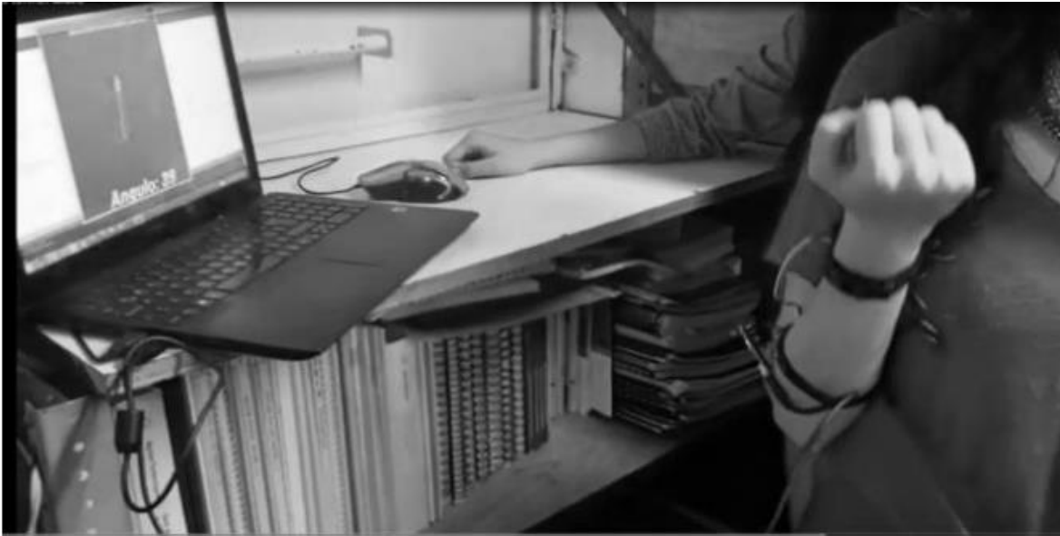
Figura 4. Goniómetro digital con IMU. Tomado de (Cuevas, de Amirola, Romero, & Rostro, 2015)
