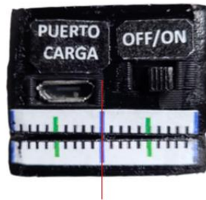
Figura 84. Alineación de los brazos del goniómetro.
