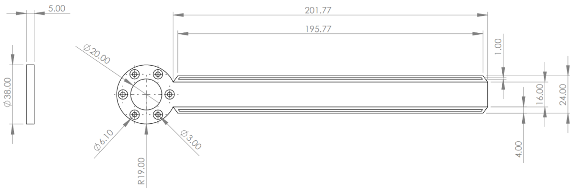
Figura 45. Dimensiones y forma de la pieza fija diseñada por CAD.
