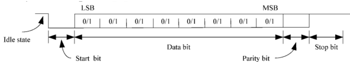
Figura 12. Trama de una transmisión UART. Tomado de (J. Norhuzaimin, 2005)
