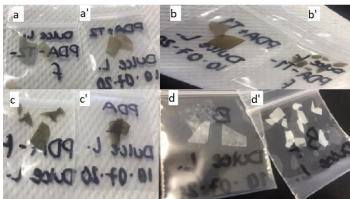
Figura 16. Muestras antes (a, b, c, d) y después (a', b', c', d') de la fotocatalisis a) PDA-T2 b) PDA-T1 c) PDA d) Blanco
