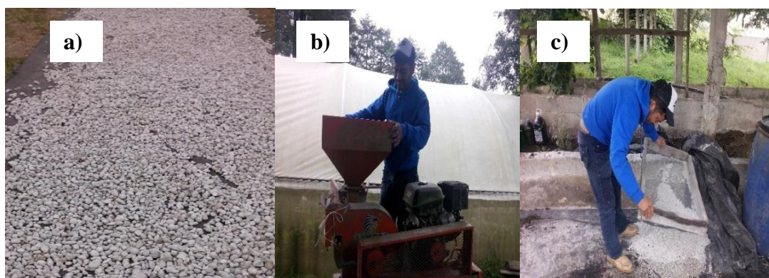
Figura 6. Preparación de la piedra pómez, a) Secado de la piedra pómez, b) Trituración de pómez, c) Tamizado.
