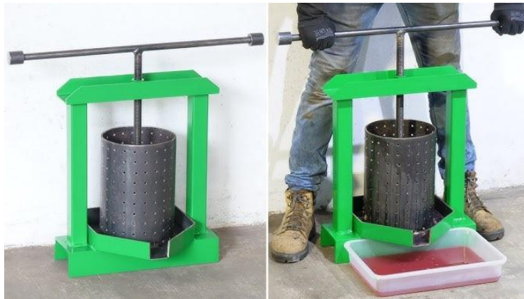
Figura 25. Exprimidor casero fabricado para extraer jugo de frutas [45].
