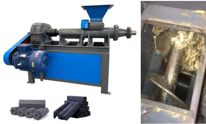
Figura 35. Uso de un torillo sin fin en briquetadora por el proceso de extrusión [83]
