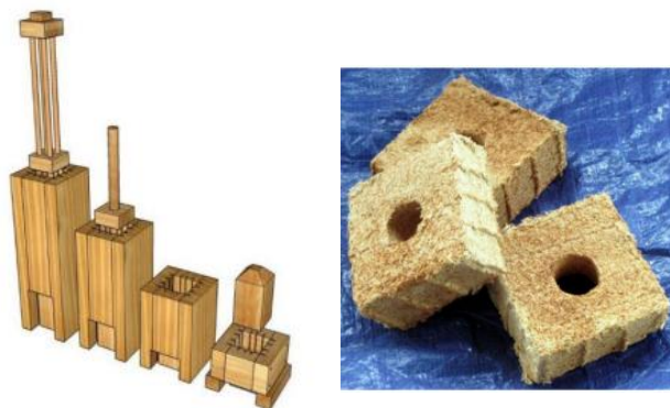
Figura 19. Molde múltiple de madera ranurado cuadrado [42]
