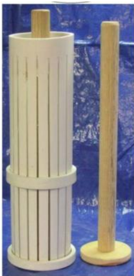
Figura 11. Molde de PVC con ranuras verticales para drenar el aglutinante y anillo de retención [42]
