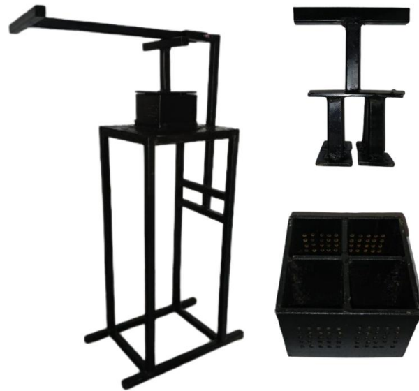
Figura 27. Modelo de briquetadora artesanal diseñado por la SMADSOT. Elaboración propia.
