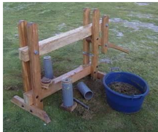
Figura 26. Modelo de briquetadora manual de palanca [46]
