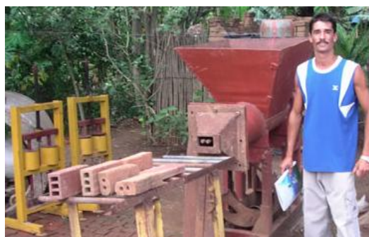
Figura 4. Producción de briquetas a partir de método artesanal (máquina amarilla) [25]
