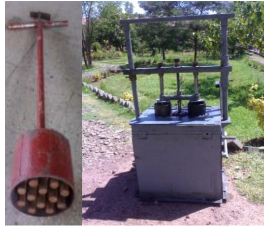
Figura 6. Moldeadores manuales para la producción de briquetas en Etiopía [28]
