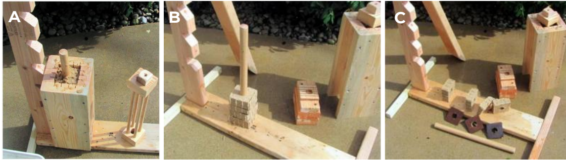
Figura 20. (A) molde de madera ranurado cuadrado (versión de cuatro briquetas), (B) briquetas expulsadas con poste, (C) elementos desmontables poste, espaciadores y briquetas [42]
