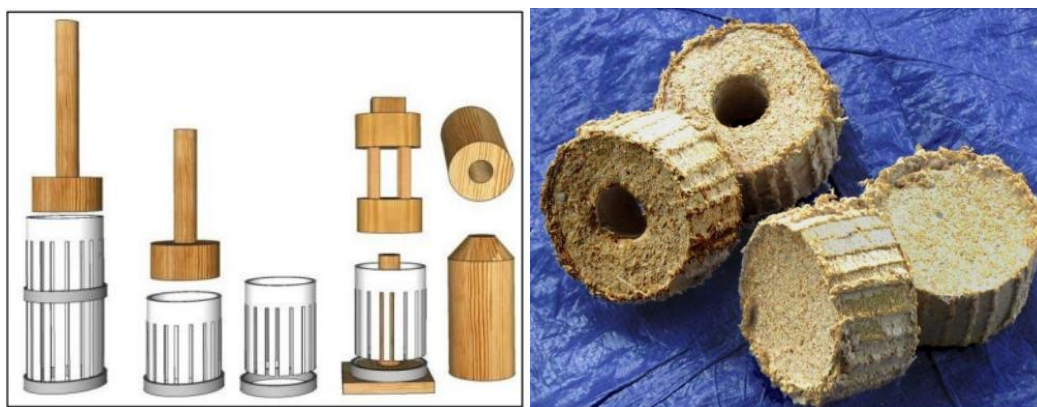
Figura 12. Proceso de briquetado con moldes de PVC con ranurado vertical. [42]
