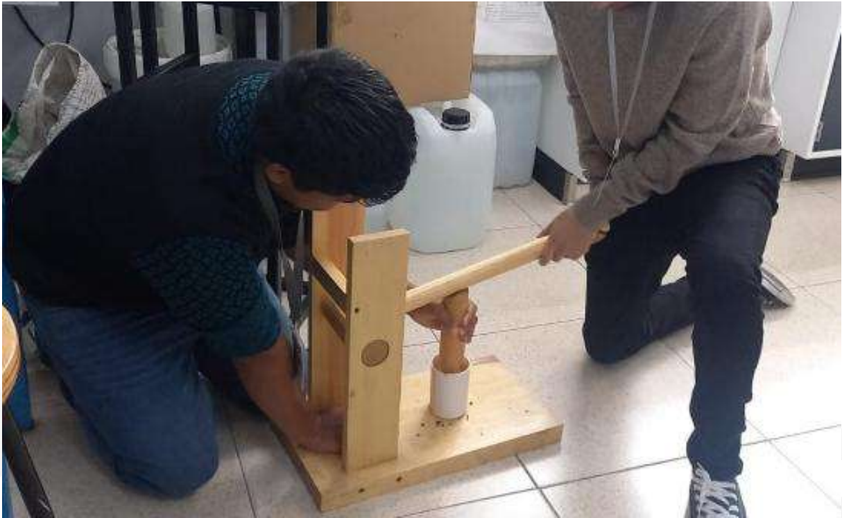
Ilustración 10 Validación en campo de la briquetadora de madera en el Laboratorio de Biocombustibles de la BUAP
