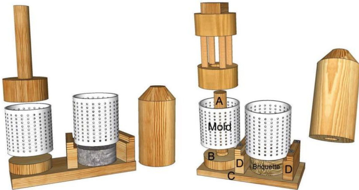
Figura 13. Moldes para la producción de briquetas sólidas y con orificio central [42]
