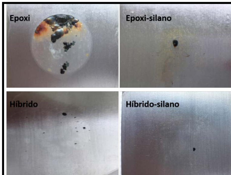
Figura 42.- Recubrimientos después de 2160 horas de inmersión a) epoxi, b) epoxi-silano, c) híbrido, d) híbrido-silano.
