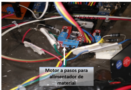
Figura 3.47: a) Puente H para alimentador de material. b) Esquema de conexión para Puente H.
