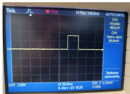
Figura 3.30: Pulso generado por el circuito.
