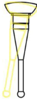
Figura 3.9: Movimiento de la punta en el palpador.
