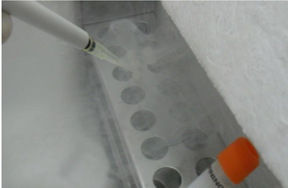
Figura 15. Vitrificación de la muestra en forma de perlas sobre un portaobjetos en vapores de N_2 (L).
