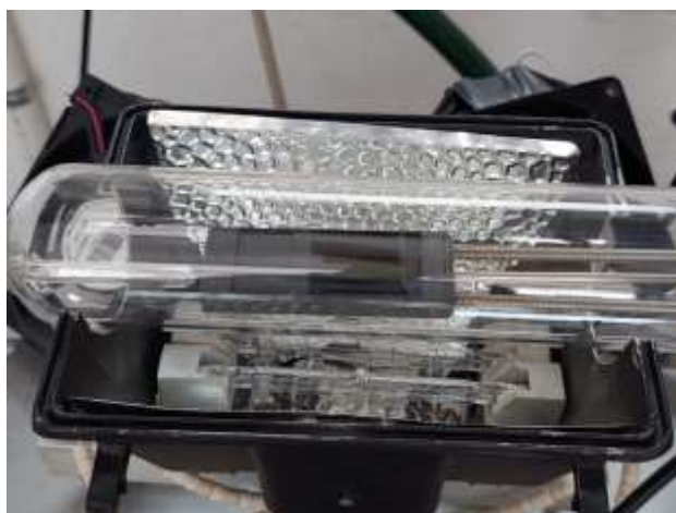
Figura A1.2. Película de CdTe colocada en el horno para el proceso de activación.
