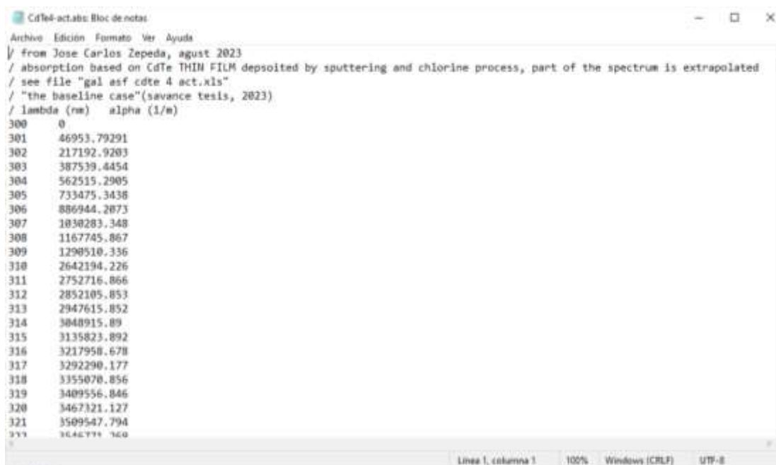
Figura 3.6. Ejemplo de archivo. abs con datos de absorción para usarse en SCAPS 1-D.
