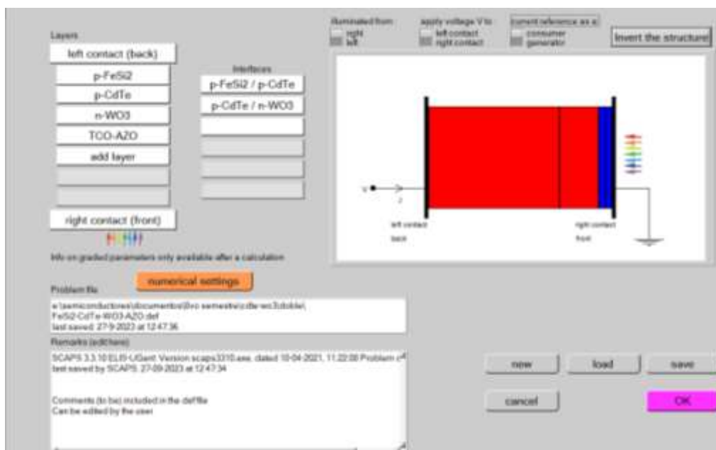
Figura 5.17. Panel de definición de celdas solares de SCAPS-1D para la estructura \text{Al}/\text{AZO}/\text{WO}_3/\text{CdTe}/\text{FeSi}_2/\text{Ni}
