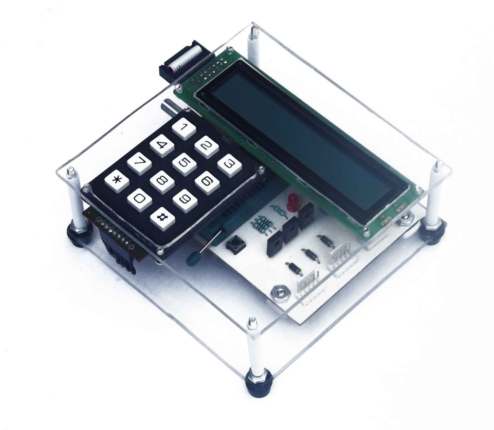
FIGURA 4.7: Consola de operación. Se distinguen dos elementos retroactivos imprescindibles en el desarrollo del proyecto: teclado y LCD. Nótese las tres terminales molex como interfaces para las tres narices que es capaz de soportar la consola.
