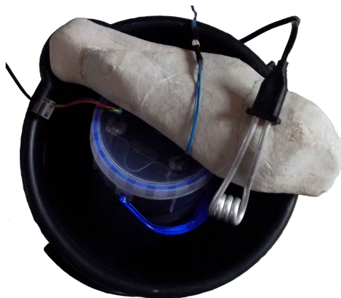
FIGURA 3.2: Baño térmico. Se tienen los valores eléctricos: V_C = 5.03 \text{ V} y R_L = 9,770 \Omega .
