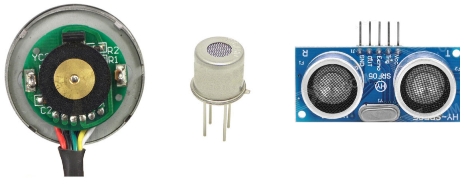
FIGURA 4.2: Tres tipos de sensores utilizados por el sistema, de izquierda a derecha: odómetro encoder , sensor químico TGS 2620 y telémetro SRF05. Su distribución: por parte del módulo, TGS 2620 y SRF05; por parte de la plataforma, encoder .
