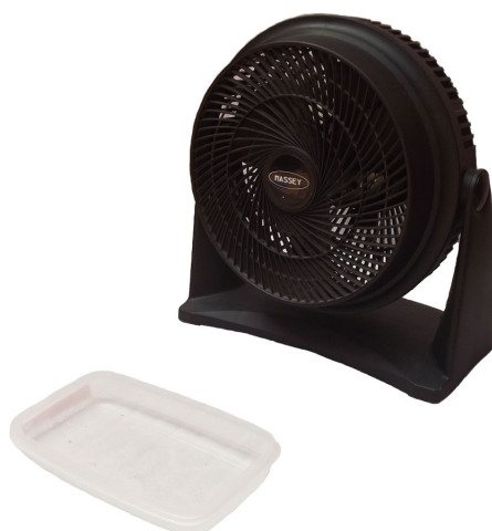
FIGURA 5.2: Fuente de gas. Se aproxima una fuga de gas mediante un ventilador de baja potencia y una charola de área 13×23 cm conteniendo alcohol etílico de farmacia.
