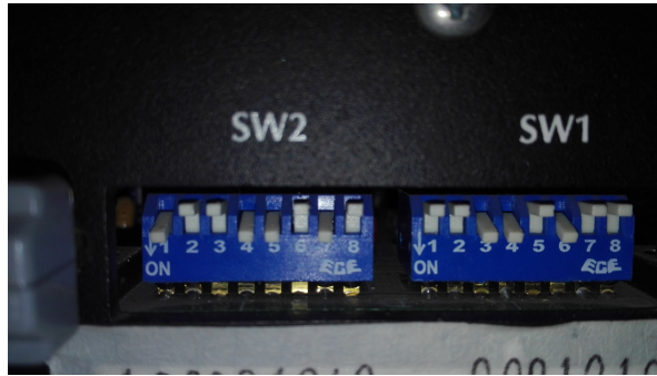
Figura IV.6: Configuración de las terminales del interruptor 2, para establecer que el Lock-in trabaje bajo el protocolo RS-232
