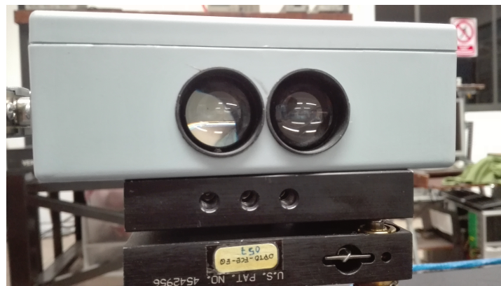
Figura II.1: Prototipo LIDAR, modelo OSLRF-01, disponible en el laboratorio de optoelectrónica de la Facultad de Ciencias de la Electrónica.
