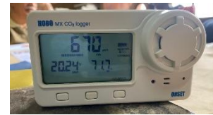
Figura 81. Equipo HOBOMX CO2 logger. Fuente: Fátima Sánchez, noviembre 2024.
