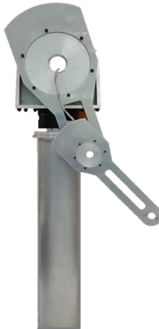
Figura 1.3: Robot manipulador de transmisión directa de 3 grados de libertad.
