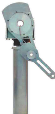
Figura 1. Robot manipulador de transmisión directa de dos grados de libertad
