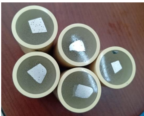
Figura 12 Muestras obtenidas después del proceso de desbaste.
