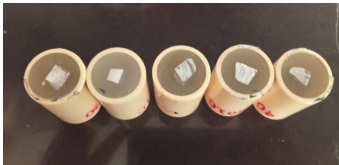
Figura 11 Muestras obtenidas después del curado de la resina.
