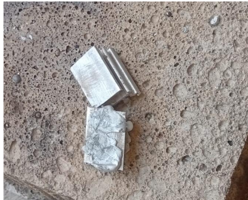
Figura 35 Piezas de aluminio unidas correspondientes a la aleación 2080.
