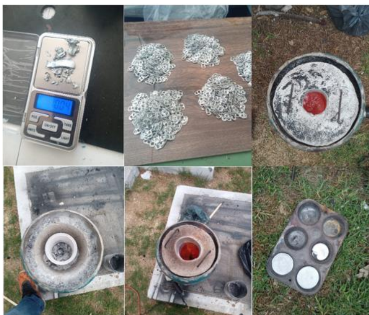
Figura 9 Proceso de obtención de aleaciones Al-Zn
