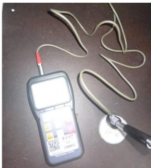
Figura 24 Toma de dureza Leeb a probetas.
