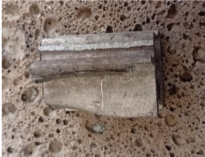
Figura 33 Pieza de aluminio deformada debido a la exposición prolongada de calor.
