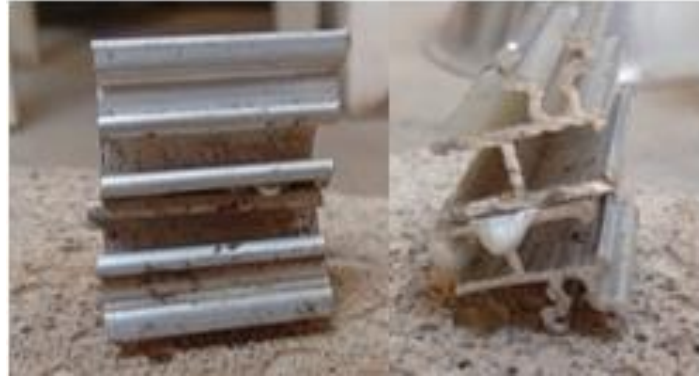
Figura 36 Piezas de aluminios soldadas correspondientes a la aleación 1090.
