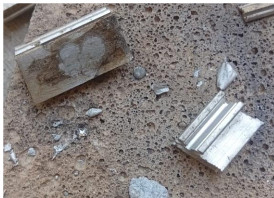
Figura 34 Pieza unida y separada correspondiente a la aleación 3070.
