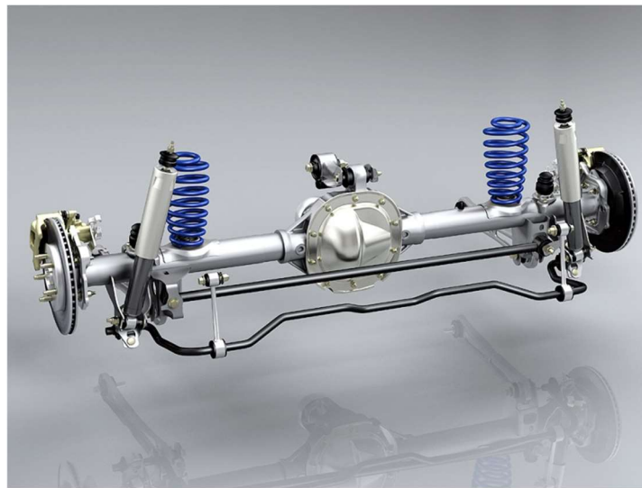
Fig. 14 Suspensión trasera de un Ford Mustang con barra estabilizadora [33].
