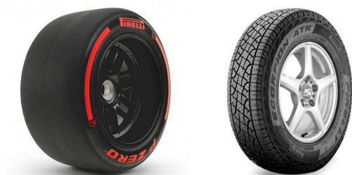
Fig. 7 Comparación de la banda de rodamiento en neumáticos de competición y vehículos particulares.
