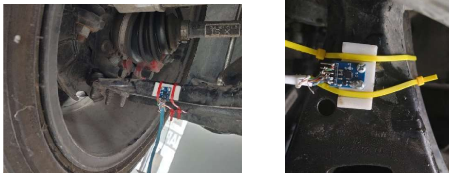
Fig. 65 Instalación de los sensores en el eje Y (lado derecho) y el eje Z (lado izquierdo).
