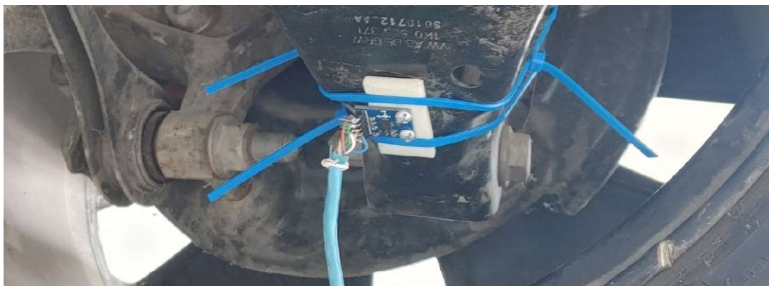
Fig. 67 Instalación de los sensores en el eje Z.
