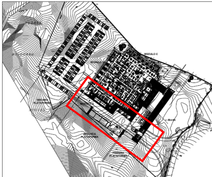
Figura 14. Área de escalonamiento para el relleno
