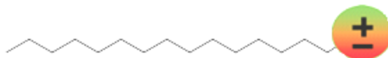
Figura 7. Carga del grupo hidrofílico de un surfactante anfótero en una solución acuosa
