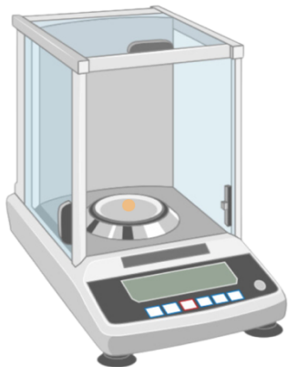
Figura 11. Balanza analítica utilizada para registrar el peso inicial y final de las muestras antes y después de inmersión en ácido clorhídrico.
