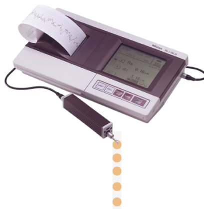
Figura 7. Perfilómetro Mitutoyo (Surftest SJ-210, Tokyo Japón) utilizado para evaluar rugosidad superficial.
