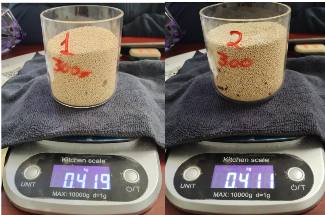
Figura 6. Zeolita 3A posteriormente activada y pesada.
