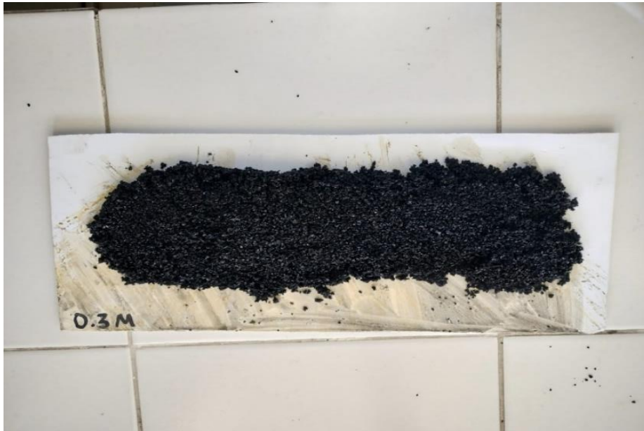
Figura 4. Carbón activado dopado con cloruro férrico secado a temperatura ambiente a 0.3 M.
