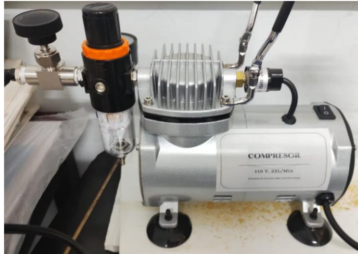
Figura 12. Compresor de aire. Marca Truper, modelo COMP-AERO (Código 17247).
