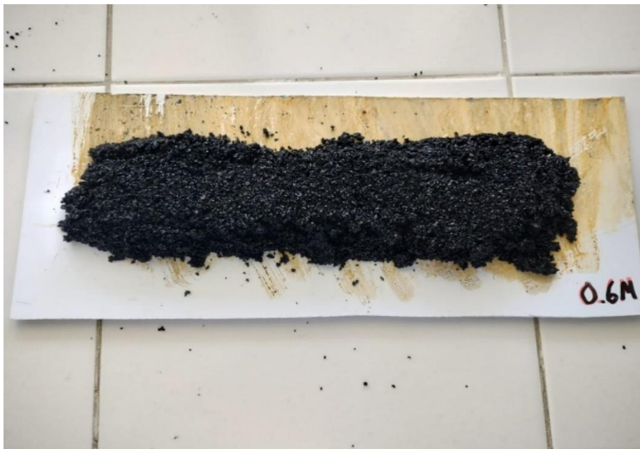
Figura 5. Carbón activado dopado con cloruro férrico secado a temperatura ambiente a 0.6 M.
