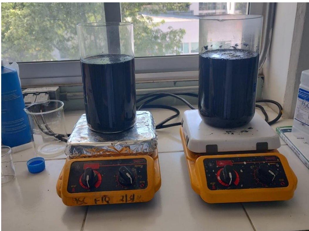
Figura 2. Carbón activado reposando en la solución de cloruro férrico.
