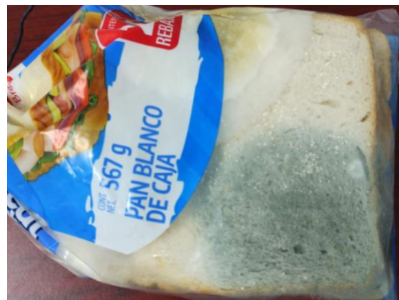
Figura 23. Resultados de las condiciones de la muestra 2 en bolsa original inyectada con N 2 .
