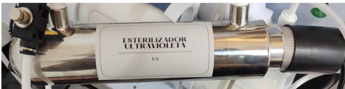
Figura 17. Lámpara ultravioleta. Marca Evans.
