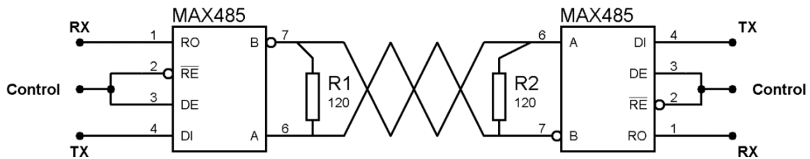
Figura 2.27. Se observa la configuración electrónica para la comunicación Half Duplex, así como 2 terminales de control para habilitar el envío y recepción de datos. TX y RX son terminales seriales provenientes de los diferentes dispositivos.
