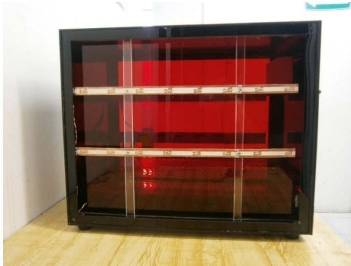
Figura 10. Imagen que muestra los sensores en la caja de actividad motora.
