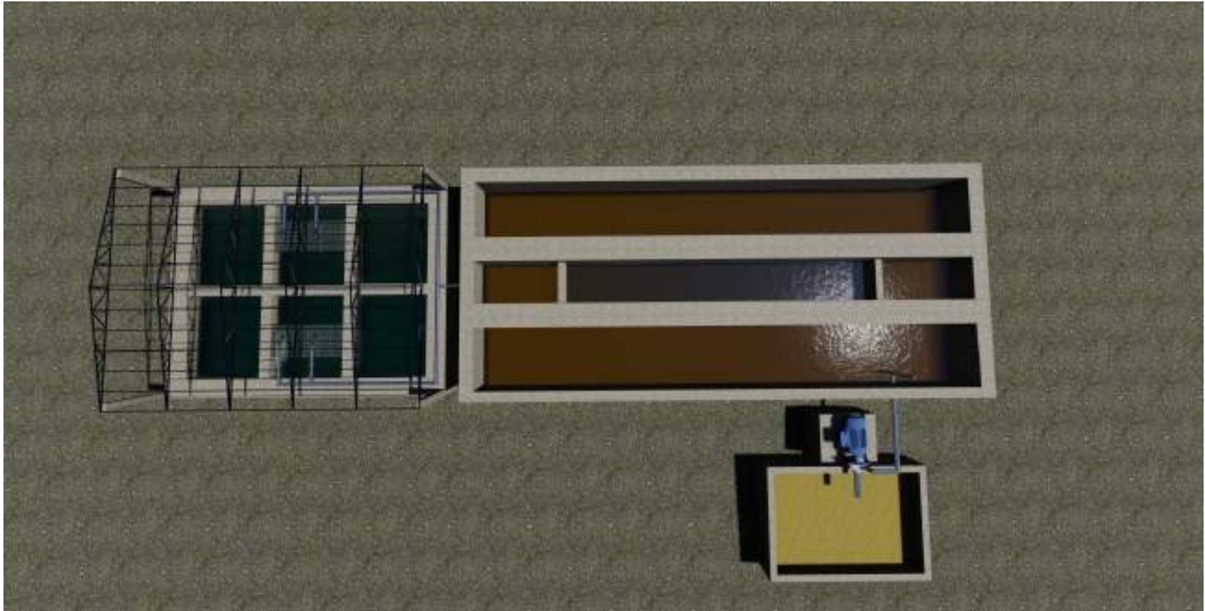
Perspectiva No. 8. Planta de tratamiento biodigestor tanque Imhoff con sistema colaborativo remoción de arena y cribado. . Elaboración propia.
