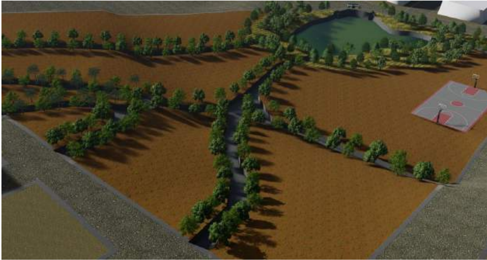
Perspectiva No. 4. Zanjas de conducción tipo 'B' y elemento de almacenamiento de agua pluvial Jagüey. Elaboración propia.
