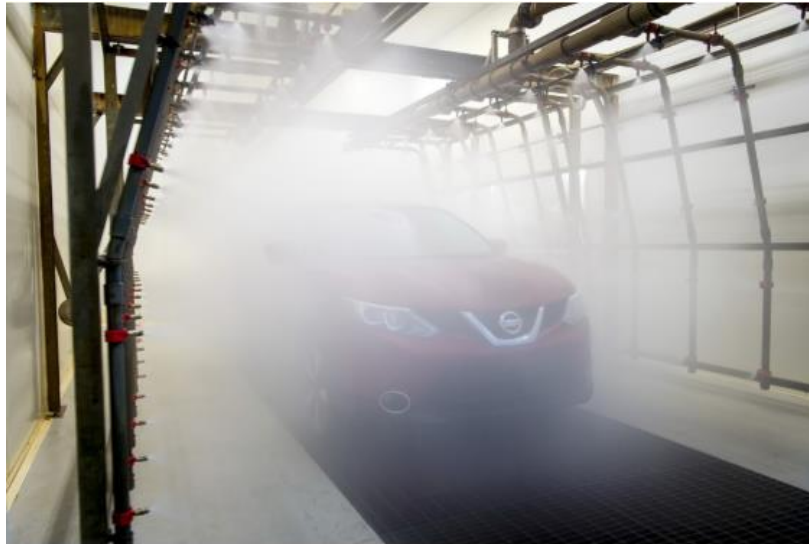
Imagen 2.23 Pruebas de Fascia delantera en cabina de agua [38].
