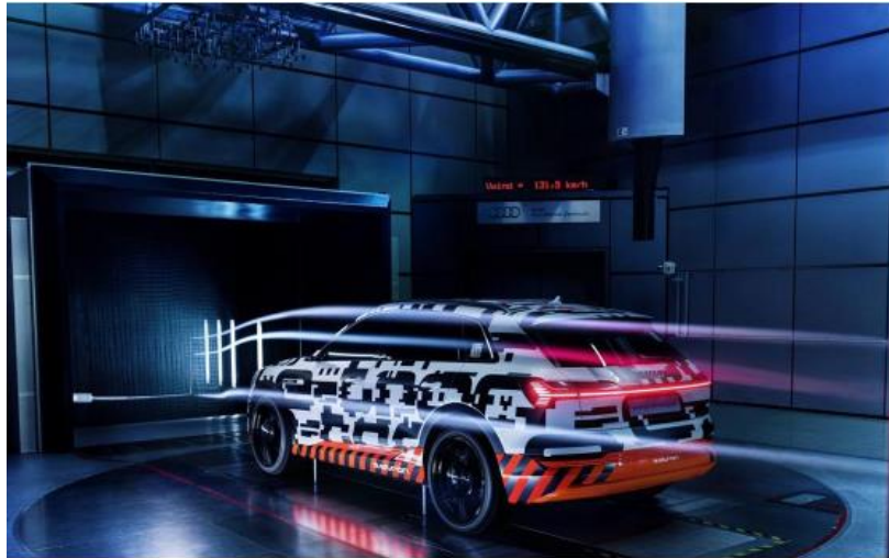
Imagen 2.22 Prueba de Fascia delantera en túnel de viento climático [21].
