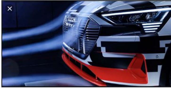
Imagen 2.21 Fascia delantera en túnel de viento [21].
