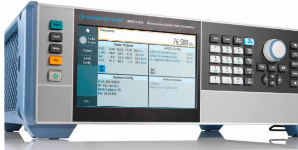
Imagen 2.29 generador de ecos de radar R&S AREG100A [16].
