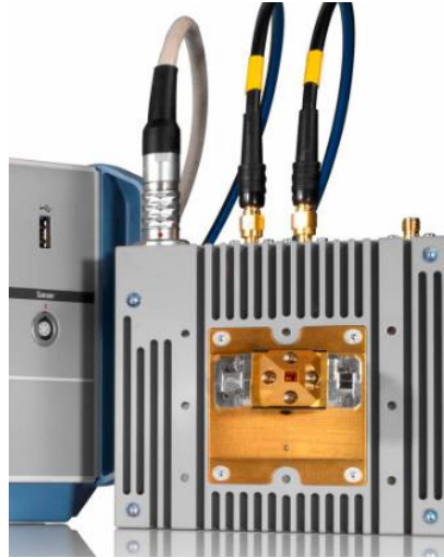
Imagen 2.30 Las pruebas de sensores de radar requieren simuladores de eco [16].
