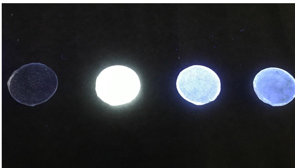
Figura 2.1: Muestras expuestas a una lámpara bajo excitación de 360 nm.
