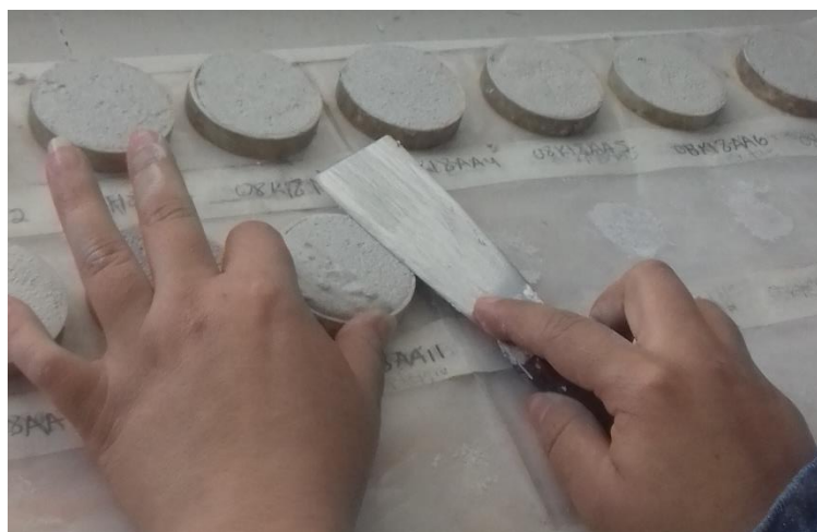
Figura 44. Enrasado de material en aro de plástico.
